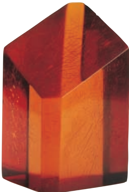
4. Un échantillon d'ORCA (anagramme d'acro), une matière plastique à base d'acroléine préparée par Charles Moureu (1863-1929) et par Charles Dufraisse (1885-1969). Ce matériau fut un précurseur et un prototype des résines acryliques.
